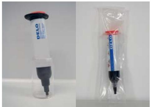
Bild 5 + 6: Konditionierung bei / auf Raumtemperatur
