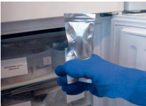
Bild 3: Entnahme des eingeblisterten Klebstoffs aus dem Gefrierschrank
