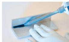
Anstelle der Originalverschlusskappe kann i.d.R. auch das benutzte Mischrohr nach Arbeitsende oder bei Pausen als Verschluss auf der Kartusche verbleiben.
