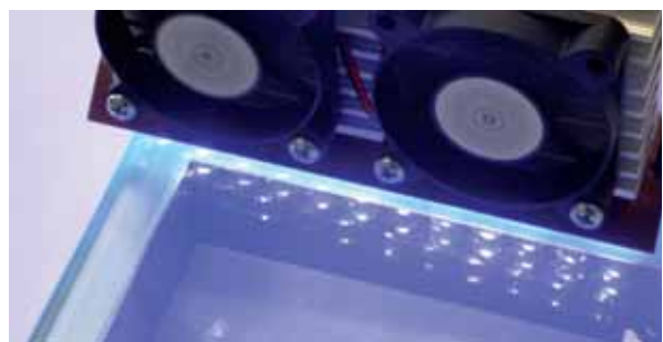
Für einen perfekten optischen Eindruck und eine unsichtbare Verklebung muss die Klebstoffraupe mit dem Rand der Leiste abschließen. Die Aushärtung kann z. B. mit LED-Modulen erfolgen.
