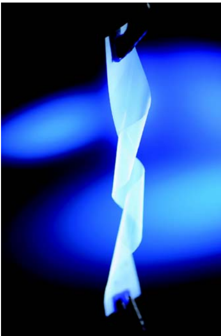
Abb. 2: Flexible Massen zur Verkapselung von flexiblen Displays
