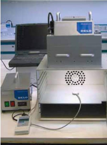
Abb. 1 Flächenstrahler wie die DELOLUX 03 S emittieren Licht zwischen 325-600 nm. Ein UVA-Messkopf in Verbindung mit einem kleinen Messgerät misst die Lampenintensität und stellt so den Aushärteprozess sicher.
